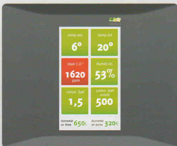
Système de mesure (SAVESYS) qui permet de suivre, en temps réels les paramètres thermiques et la qualité d'air d'une habitation.
